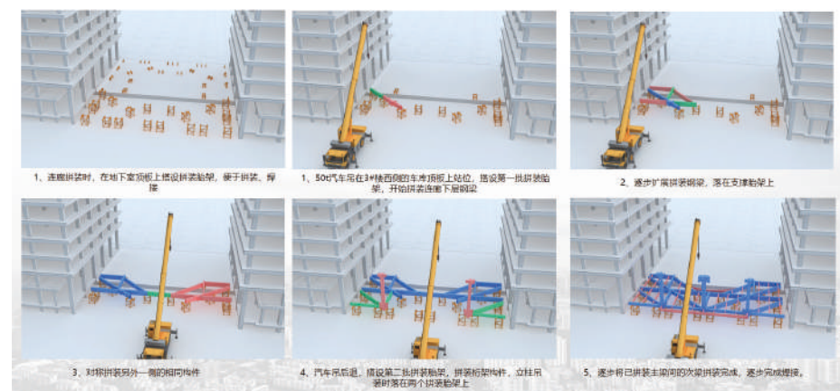
钢结构施工模拟
